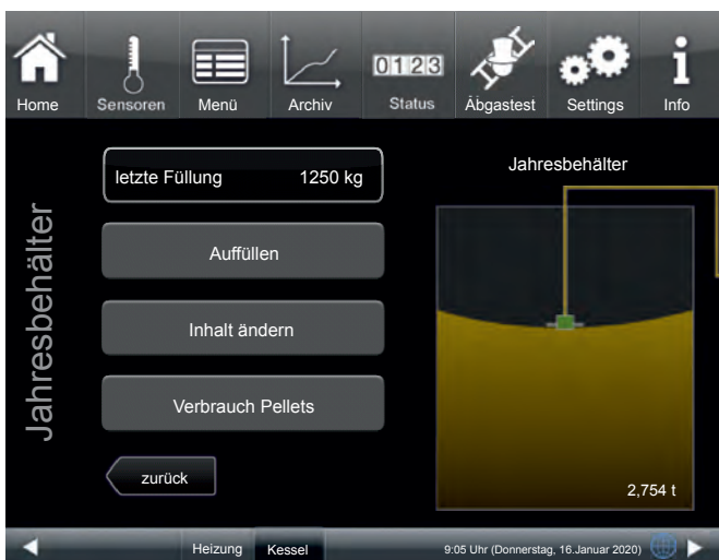
Bedienoberfläche BPH 4/17: Menü „Jahresbehälter“ (Gewebesilo mit Saugentnahme von oben).
