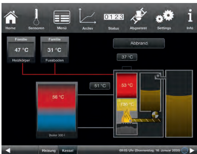
Bedienoberfläche BRUNNER BPH 4/17 (Brennwertgerät). Verbaut in einer bestehenden Heizungsanlage als Ersatz für einen alten Ölkessel.
