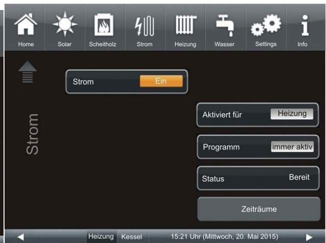
Abbildung 5: Zusatzheizung 2 Seite 2: mit Strom (Elektroheizstab ohne Möglichkeit der Leistungsmessung)
