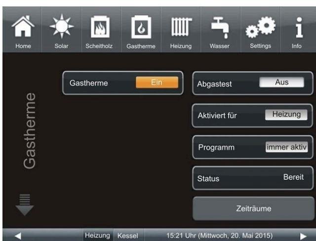
Abbildung 4: Zusatzheizung 1 Seite 1: mit Gastherme
