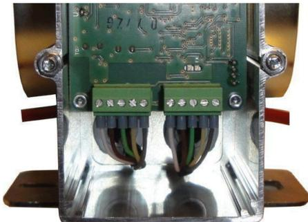
Abbildung 9: Luftklappenstellmotor K1
