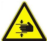
Bei Arbeiten an Klappe, Drehteller oder Schiebepplatte zur Zu- / Abluftregulierung, sowie deren Mechanik, ist die Steuerung (EAS / EOS) vor Arbeitsbeginn von der Versorgungsspannung (230VAC) zu trennen und warten Sie ab bis der Antrieb über die Batterie der Steuerung vollkommen aufgefahren ist (maximale Laufzeit 2 Minuten).
