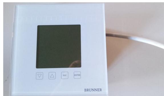
Abb. 5: Glasdisplay aufmontiert
