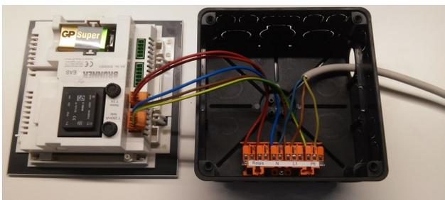
Abb. 4: Verbindung durch Anklemmen zwischen Bedienteil und Unterputzkasten
