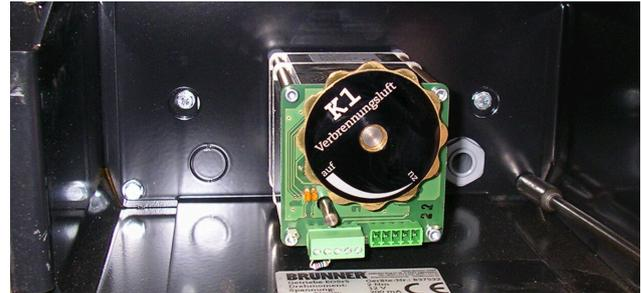
Abb. 4: Montagewinkel incl. Motor lösen
