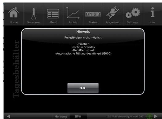
Die automatische Pelletförderung ist die Regel, eine manuelle Beschickung erfolgt nur im Notbetrieb.
