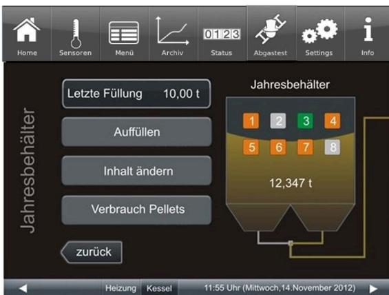
Die Farbe der Symbole der Saugsonden wechselt (blinkt) in eine braune Färbung, so lange sie die Pellets ansaugen.
