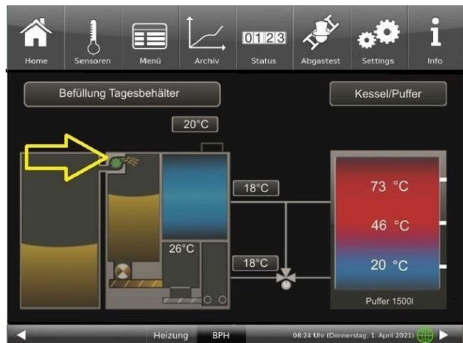
Der aktuelle Füllstand im Jahresbehälter wird über den Status "letzte Füllstandeingabe" mittels Differenzbildung mit der danach verbrauchten Pelletmenge ermittelt und grafisch dargestellt:
