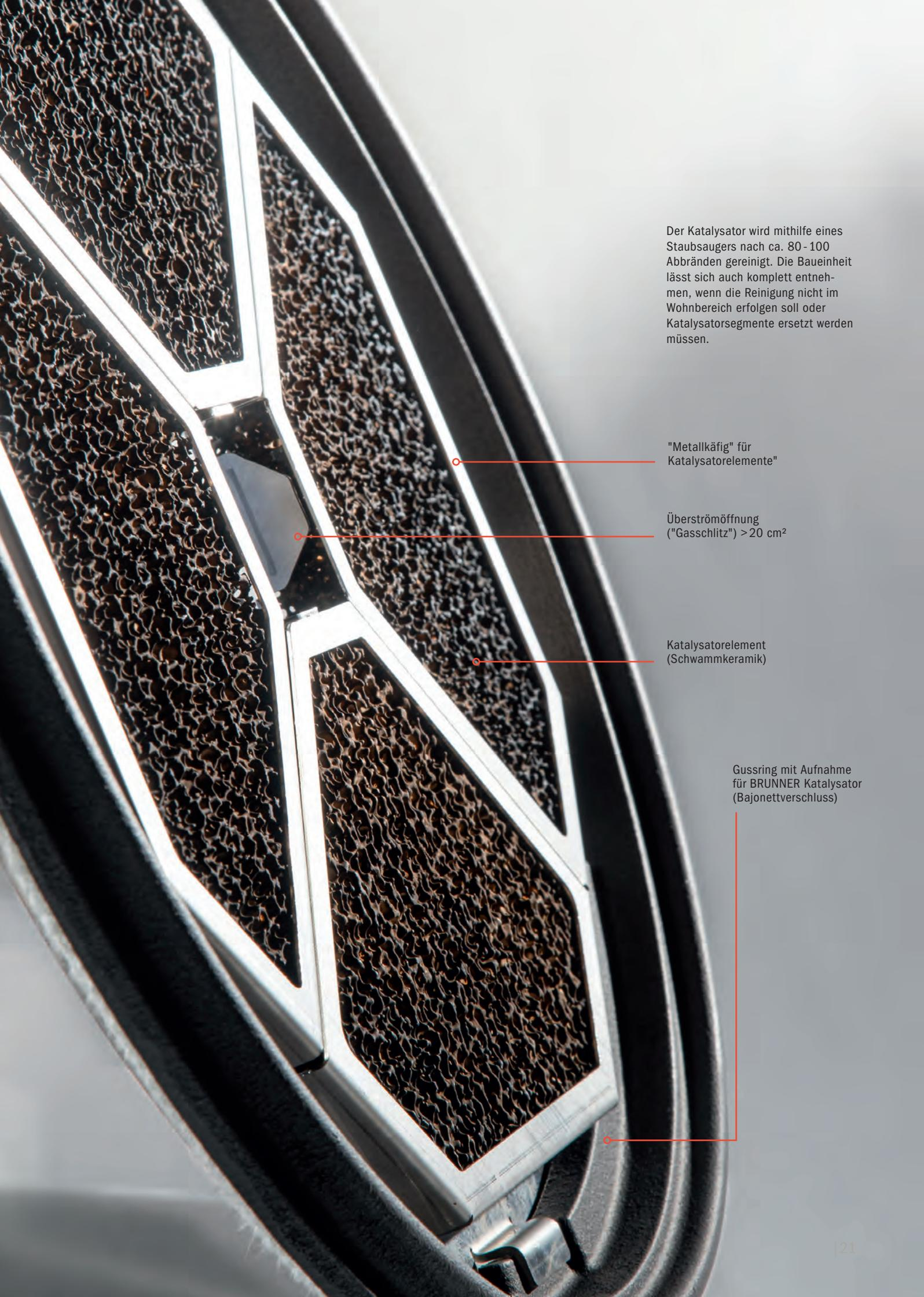
Der Katalysator wird mithilfe eines Staubsaugers nach ca. 80 - 100 Abbränden gereinigt. Die Baueinheit lässt sich auch komplett entnehmen, wenn die Reinigung nicht im Wohnbereich erfolgen soll oder Katalysatorsegmente ersetzt werden müssen.
