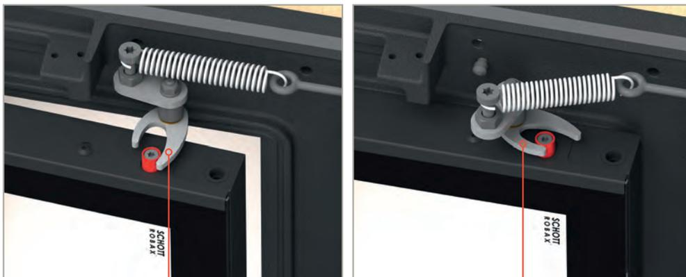
Beim Schließvorgang drückt die Verschlusshülse (rot) auf die Aufnahme des Verriegelungsarmes.
