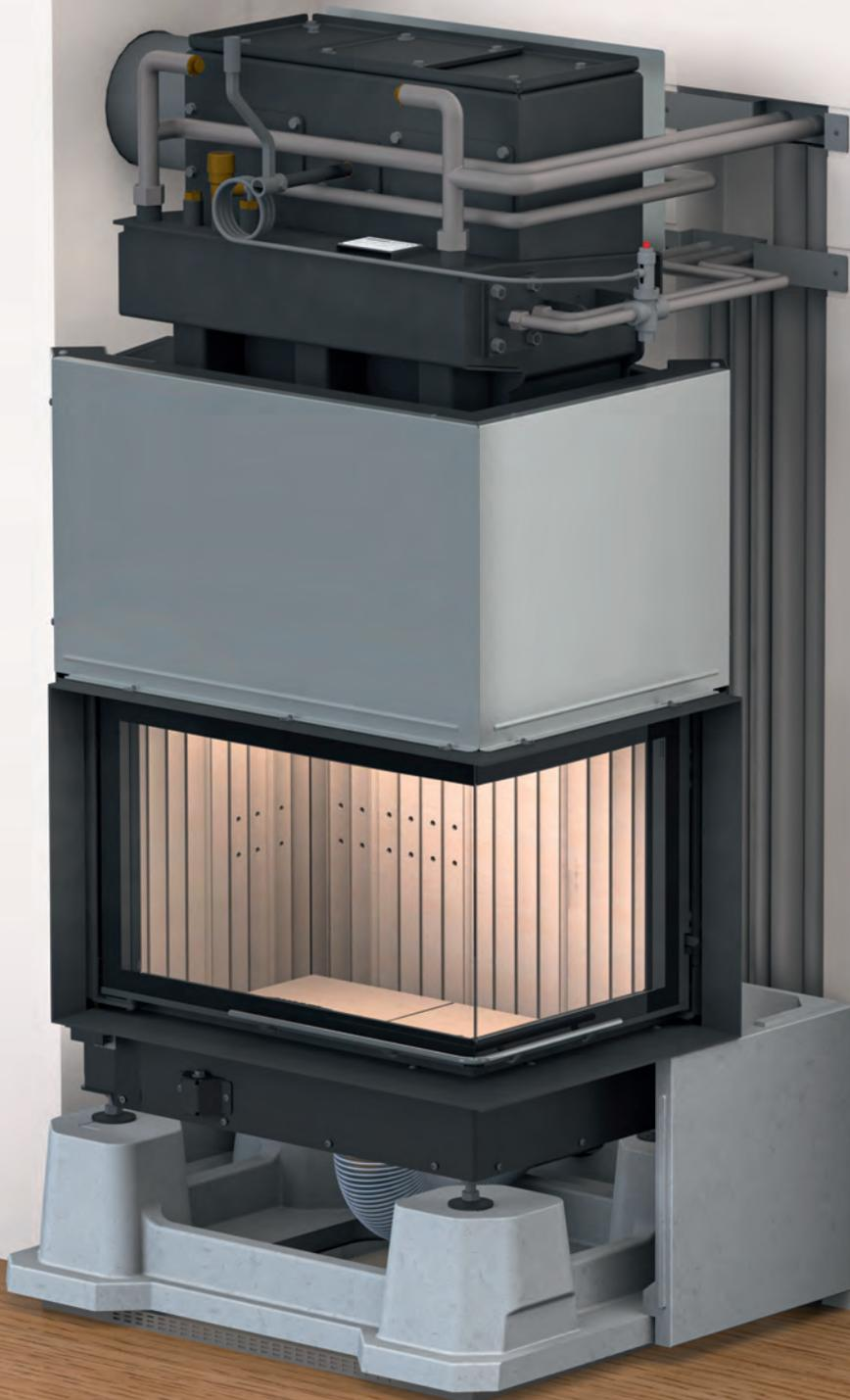
wasserführender Systemkamin BSK 02 - die hydraulische Leitungsführung in der Wandaussparung erfolgt vor Aufbau des BSK. Nach Ausrichten der Grundplatte wird das untere Hüllenelement im Eckbereich gesetzt und der Durchgang für die Verbrennungsluftleitung erstellt. Danach werden der Kamineinsatz und die nachfolgenden Ringelemente gesetzt.
