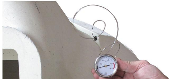
Abb. 18: Zeigerthermometer in Kuppel
