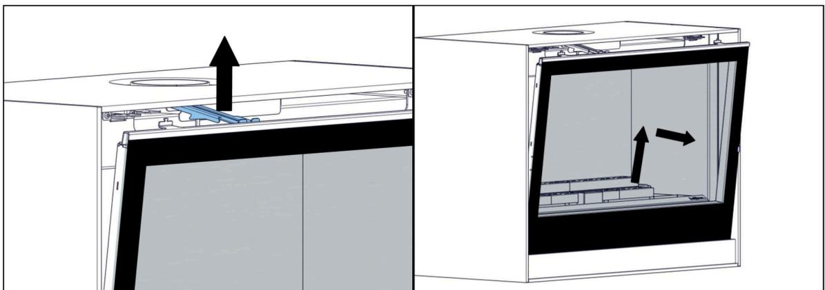
4. Kippen Sie die Tür und die Glasscheibe vorsichtig nach vorne. Vermeiden Sie Beschädigungen. Ziehen Sie die Tür nach oben und entfernen Sie sie vom Gerät.
