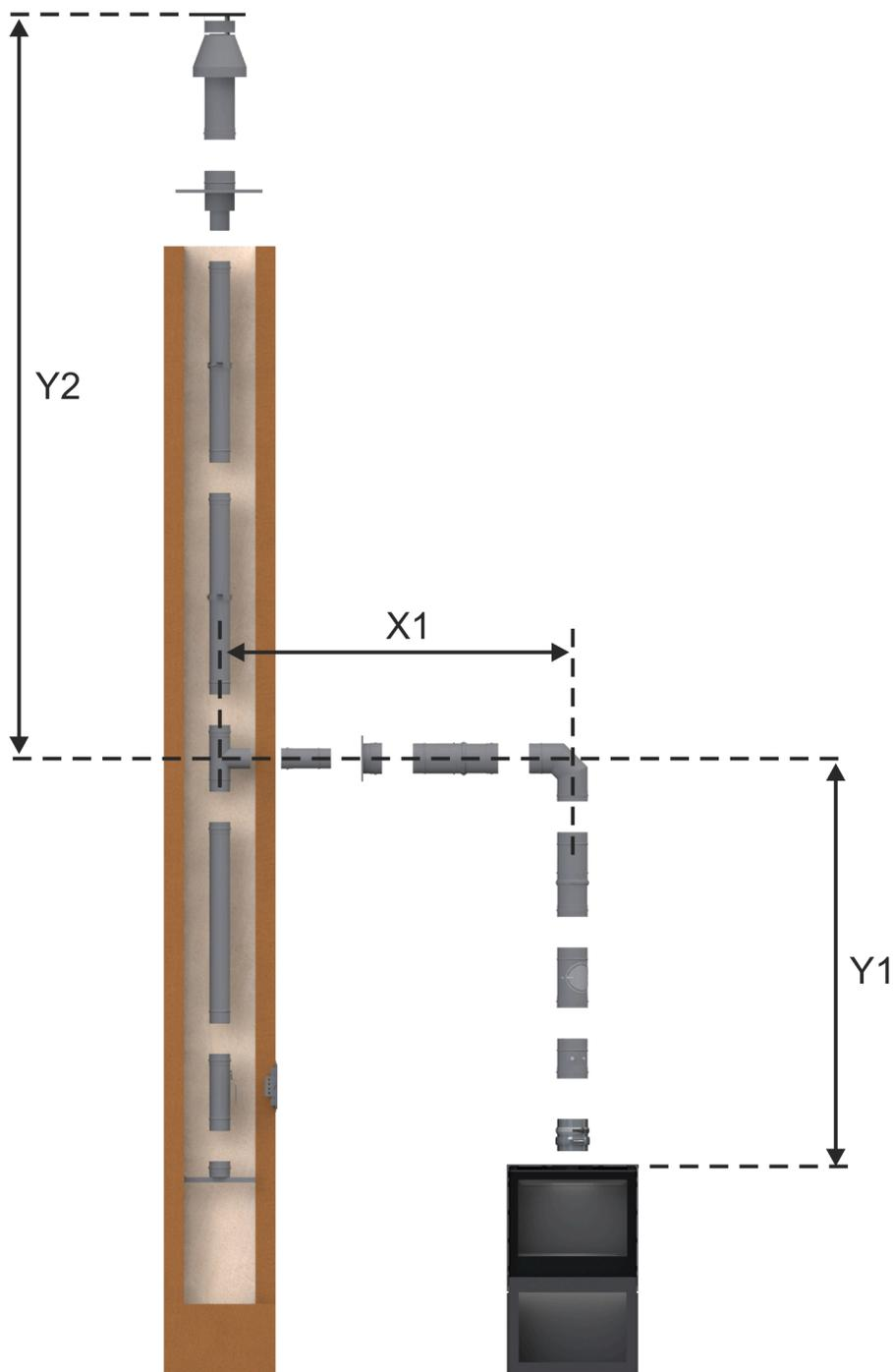
**LAS Nr. 5: Rohrführung D=100/150 mm im Schacht (C<sub>91</sub>; Abgasstutzen D=100/150 mm)**
