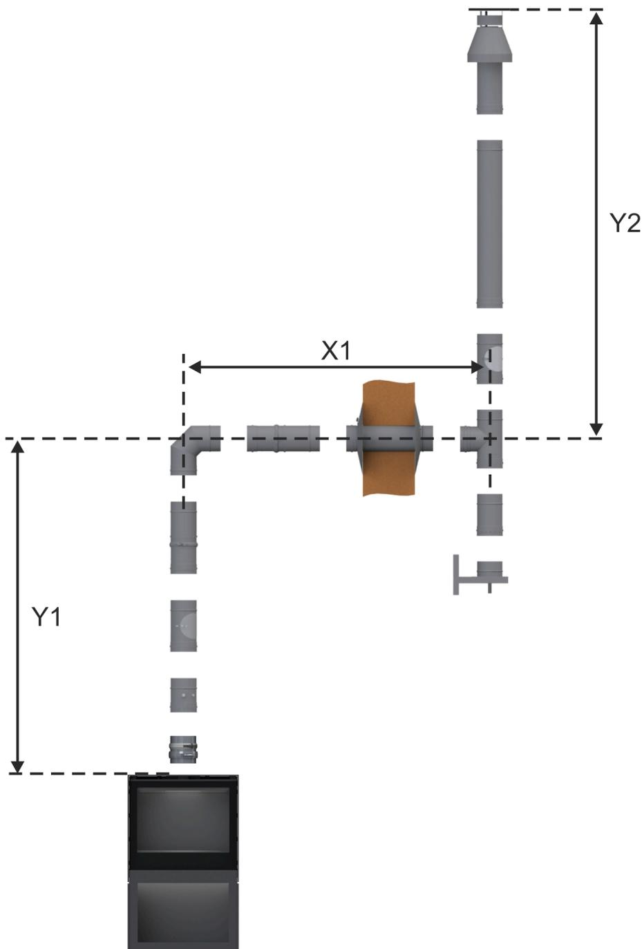
**LAS Nr. 7: Außenschornstein D=100/150 mm mit Abgasmündung über Dach (C<sub>31</sub>; Abgasstutzen D=100/150 mm)**
