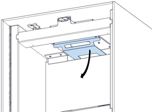
2. Schrauben Sie die beiden Halteschrauben nach dem Entfernen der Umlenplatte wieder in die Gewinde im Inneren der Brennkammer ein.
