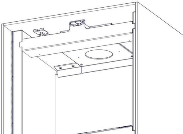
Die Umlenplatte ist entfernt. Das Gerät darf mit Stauplatte, jedoch ohne Umlenplatte, nicht betrieben werden.
