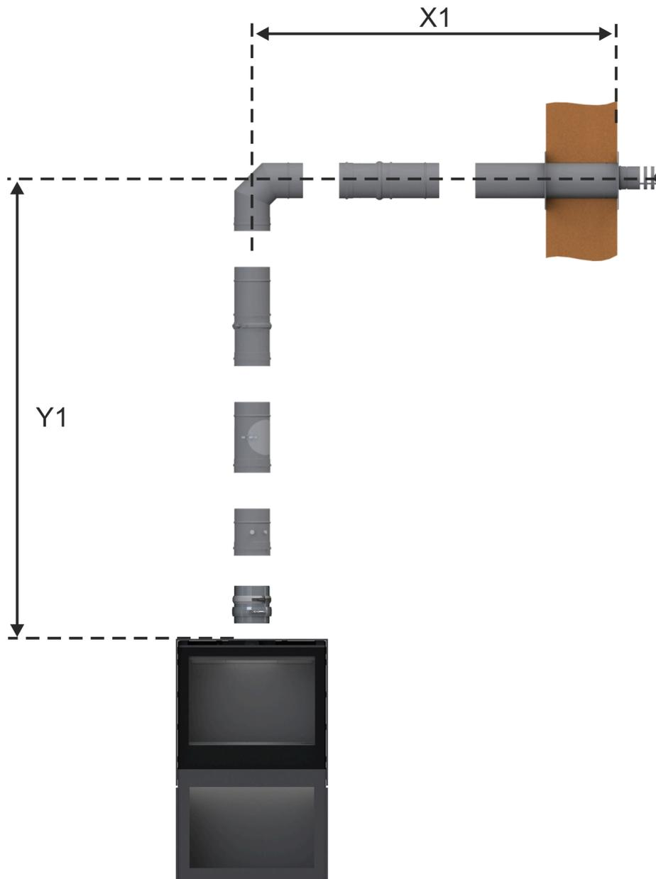
**LAS Nr. 9: Außenwandanschluß D=100/150 mm (C<sub>11</sub>; Abgasstutzen D=100/150 mm)**
