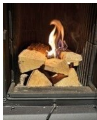
Anordnung von Anzünder, Anzündhölzchen und Holzscheite für das Anheizen von oben
