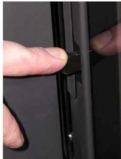
Abb. 3: Öffnen der Eck-Feuerungstür links zur Reinigung
