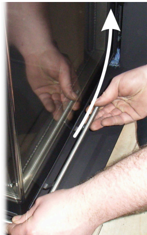
Abb. 6: Schließen der Eck-Feuerungstür rechts
