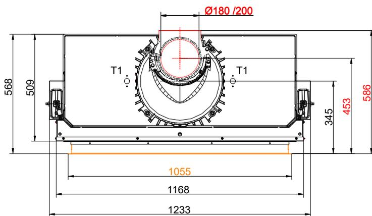
... Blendrahmen und Wärmetauscherringe Guss + Gusskuppel
