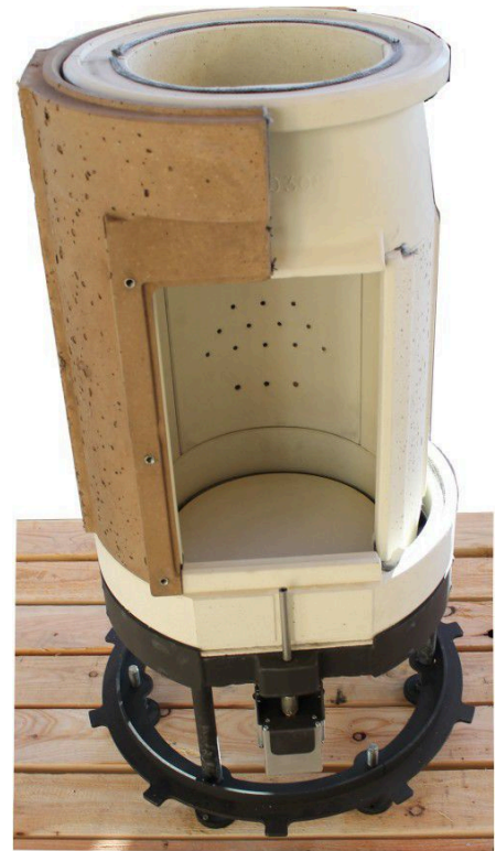
Abb. 18: Innenring vorn und Außenschale links aufgesetzt
