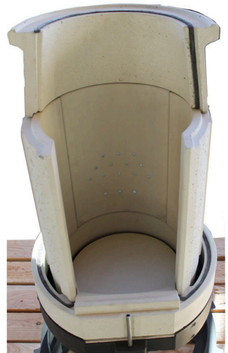
Abb. 17: Zwischenring hinten montiert und ausgerichtet
