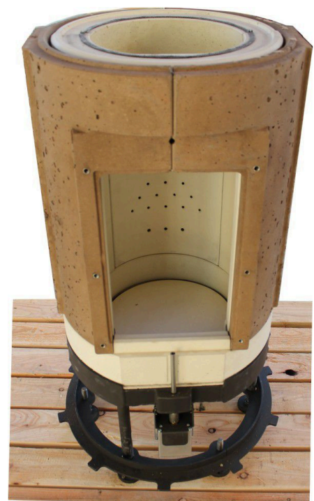
Abb. 19: Außenschalen montiert und ausgerichtet
