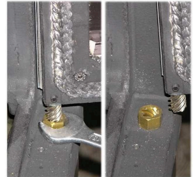
Abb. 26: Scharnierbolzen auf Ge- windehülse setzen und Höhe ein- stellen durch Drehen der Gewinde- hülse
