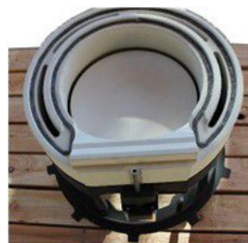
Abb. 13: Basisring und Boden aufgelegt
